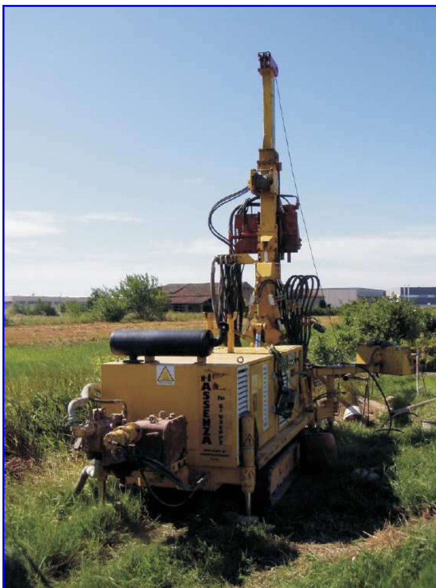
Fotografia 1 – Impianto cantiere per la realizzazione del sondaggio
