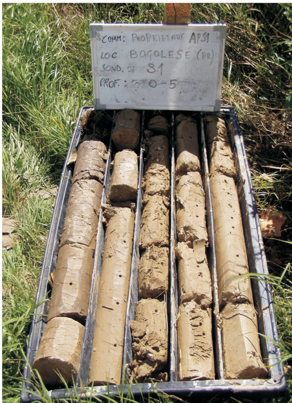
Cassa n°1 del sondaggio a carotaggio continuo S1 (0,00 - 5,00 metri)
