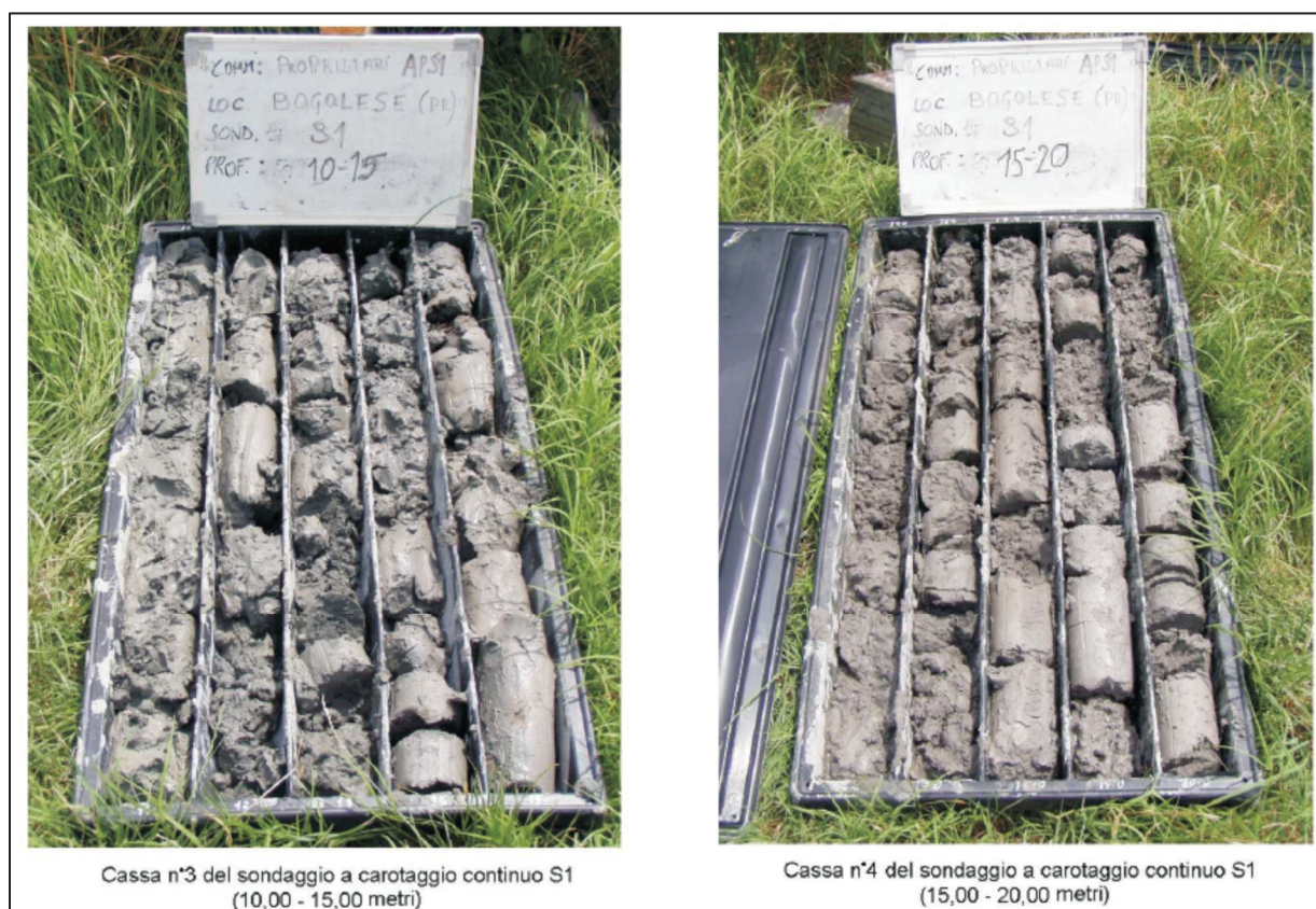
figura 7: foto del carotaggio dai -10 ai -20 m (estratte dalla relazione geologica del 2008)
