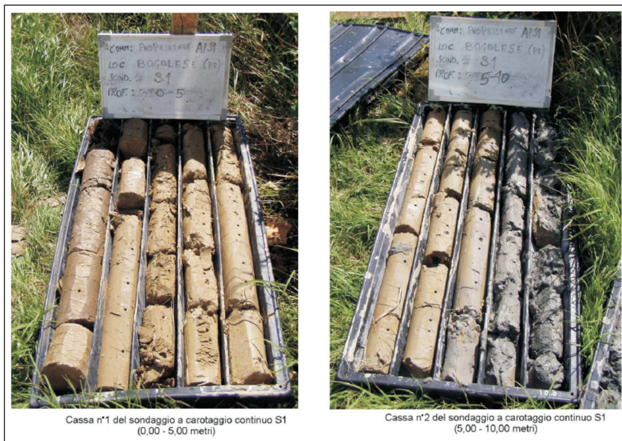
figura 6: foto del carotaggio dal piano campagna ai -10 m (estratte dalla relazione geologica del 2008)
