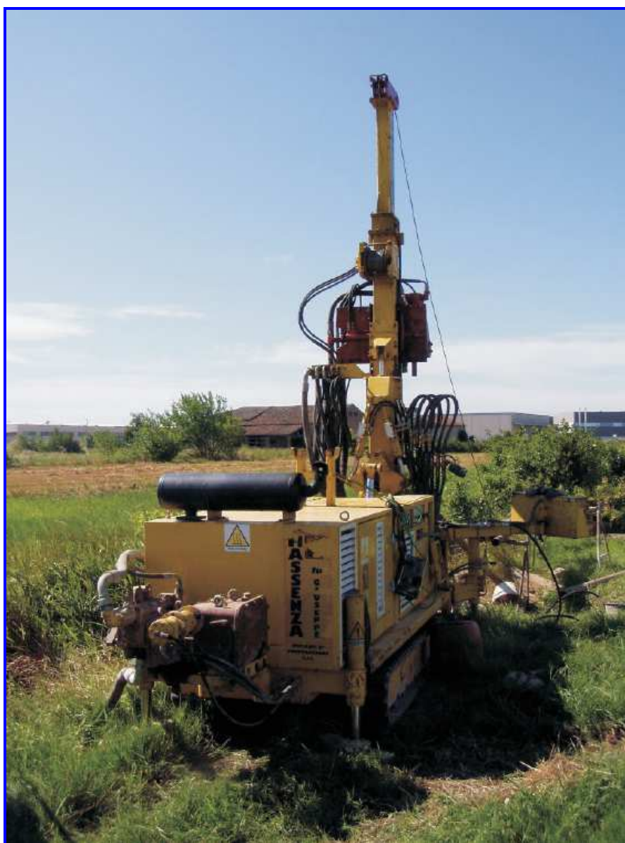
Fotografia 1 – Impianto cantiere per la realizzazione del sondaggio
