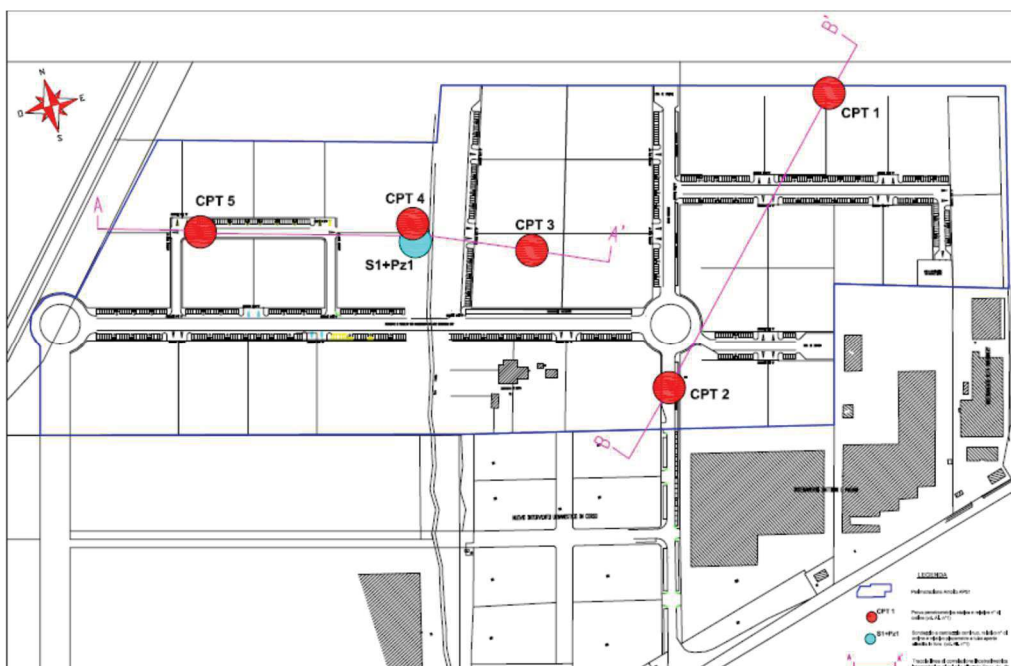
figura 5: elaborato di progetto 2008 con ubicazione prove penetrometriche e carotaggio (cerchio azzurro)
