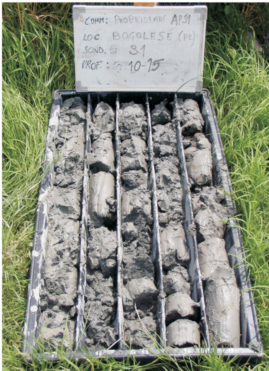
Cassa n°3 del sondaggio a carotaggio continuo S1 (10,00 - 15,00 metri)
