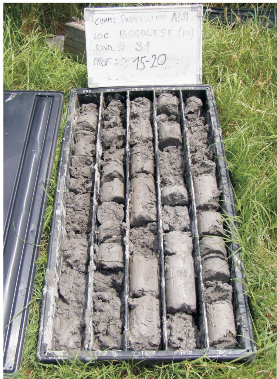
Cassa n°4 del sondaggio a carotaggio continuo S1 (15,00 - 20,00 metri)
