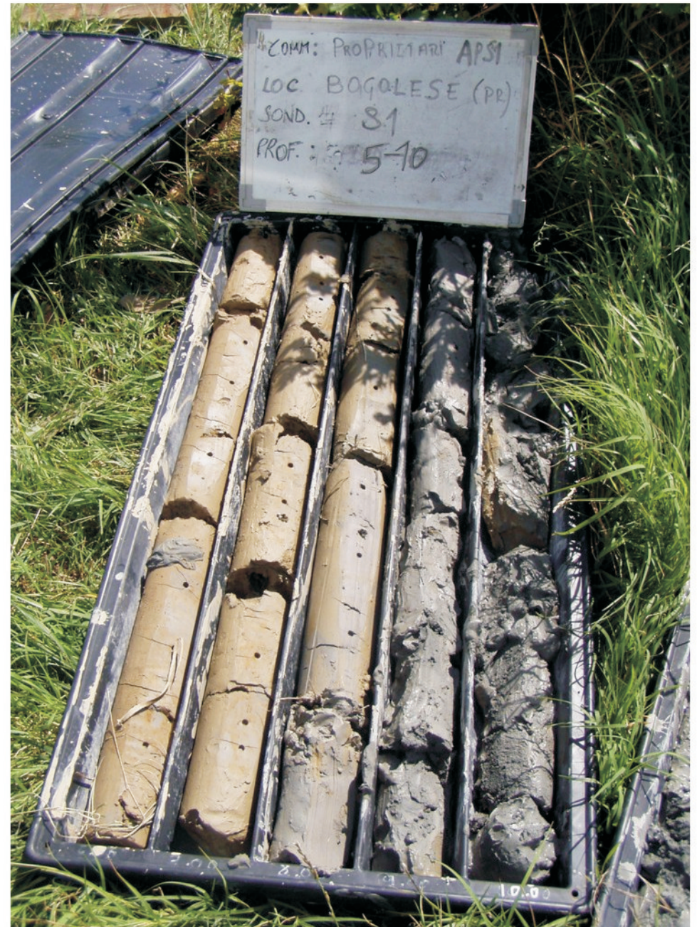
Cassa n°2 del sondaggio a carotaggio continuo S1 (5,00 - 10,00 metri)
