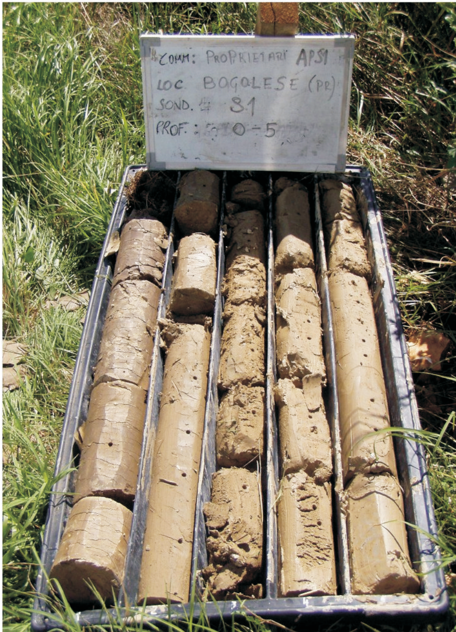
Cassa n°1 del sondaggio a carotaggio continuo S1 (0,00 - 5,00 metri)
