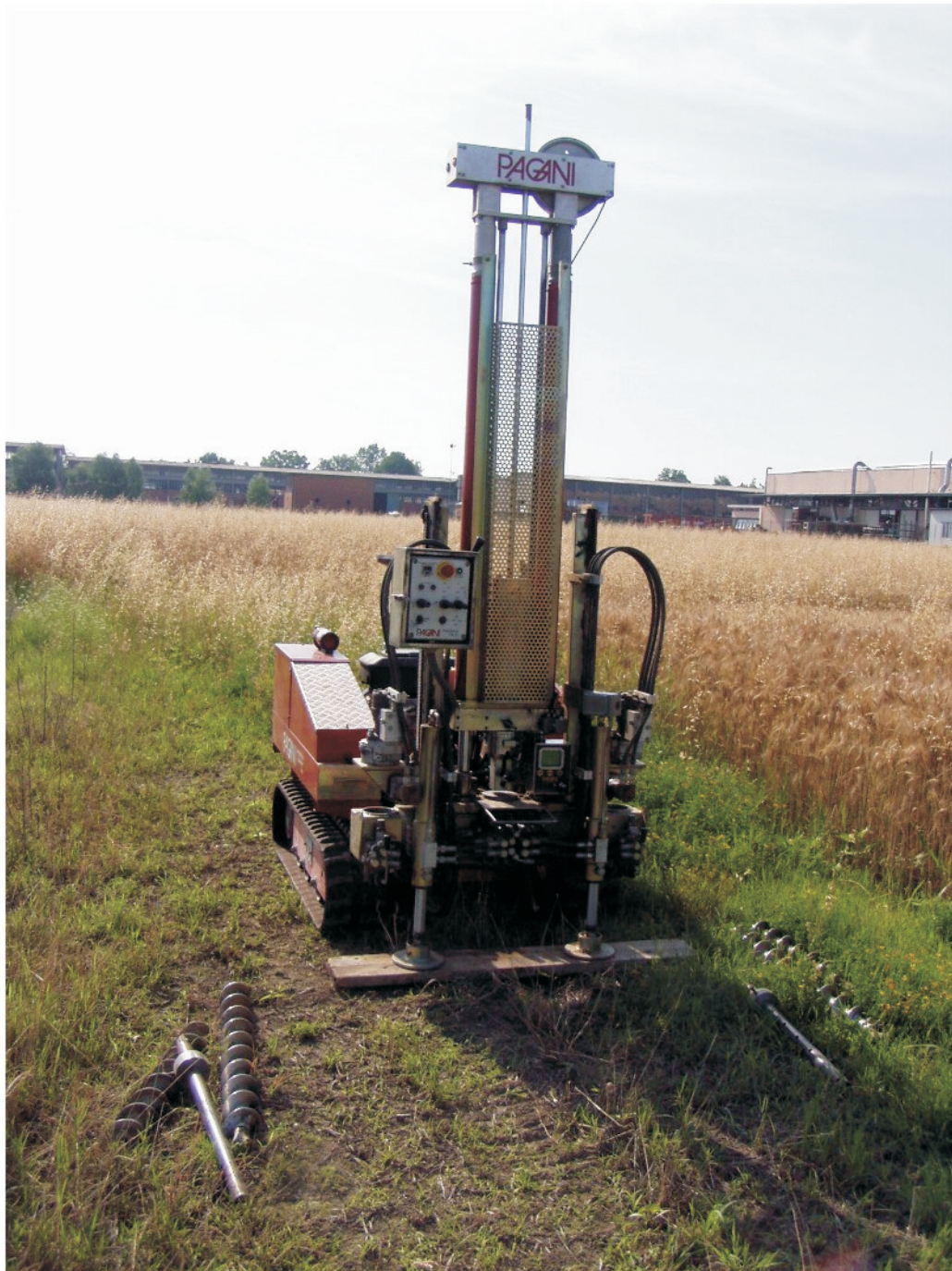
Documentazione fotografica della strumentazione di indagine (Penetrometro PAGANI - 20 tonn)
